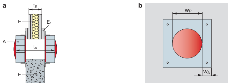
Abb. 2: Rahmung und Aufleistung der Abschottung in Wänden/Decken.
