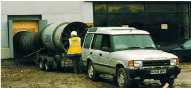
„Blower door test“
