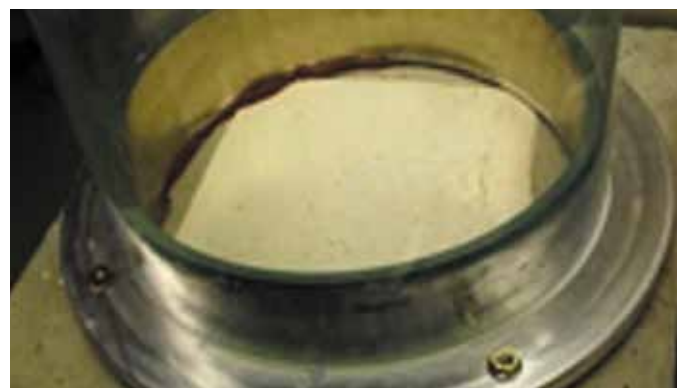
CFS-S SIL mit Flansch und Plexiglasrohr montiert.
