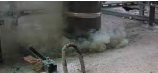
Rauchentwicklung bei einem unzureichend abgeschotteten Kunststoffrohr im Brandversuch nach 8 Minuten.
