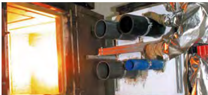
Brandtestofen im Hilti Forschungs- und Technologiecenter.
